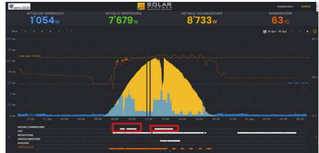
Unsere neue Regelung mit Sollwert-Optimierung
